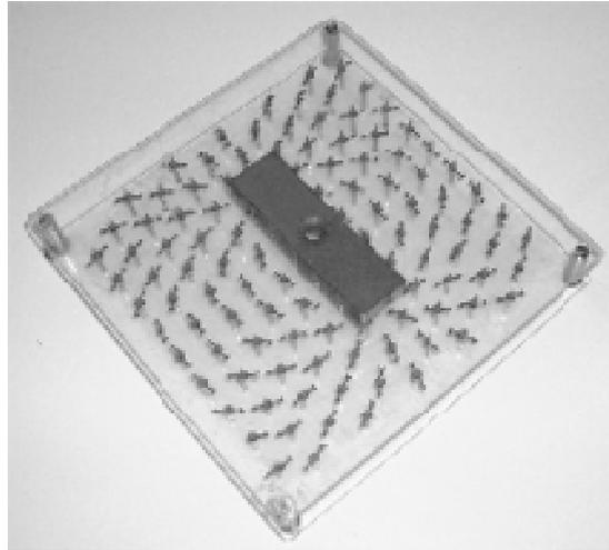
*En présence d'un champ magnétique, des petites boussoles s'orientent, indiquant la direction et le sens des vecteurs du champ.*
